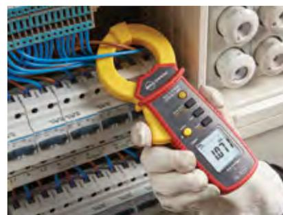
Medida de corriente diferencial con pinza amperimétrica de corriente de fuga
