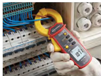
Jäännösvirran mittaaminen vuotovirtapihdillä
