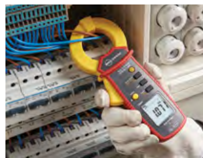
Mesure de courant différentiel avec pince de courant de fuite
